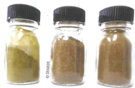
LES POUDRES EXTRAITES DES PLANTES HYPERACCUMULATRICES, À PARTIR DESQUELLES LES CATALYSEURS SONT FABRIQUÉS.
